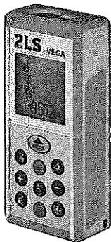
**TOPCON製レーザー距離計 VEGA**
